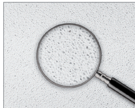
Pórobeton tvoří ze sta procent ryzí přírodní. Vyrábí se ze směsi křemičitého písku, vápna a vody. Proto patří mezi „nejčistší“ a hygienicky nejpříznivější materiály pro použití v bytových nebo občanských stavbách.
