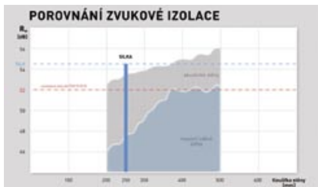
Tvárnice SILKA převyšují jiné zdicí materiály hlavně svými zvukověizolačními schopnostmi při minimálních tloušťkách stěn.
