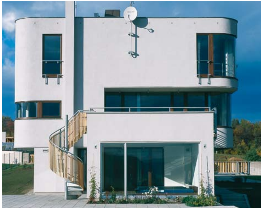
Oblé tvary v architektuře mají své kouzlo. Dosažení dokonalých křivek s jiným materiálem, než s pórobetonem YTONG, by ale byl velký problém. Nehledě na výsledné vlastnosti obvodových stěn, které se při použití tvárnice YTONG obejdou i bez zateplení. V případě zateplení potom získáte skutečně nadstandardní nízkoenergetický nebo dokonce pasivní dům.
