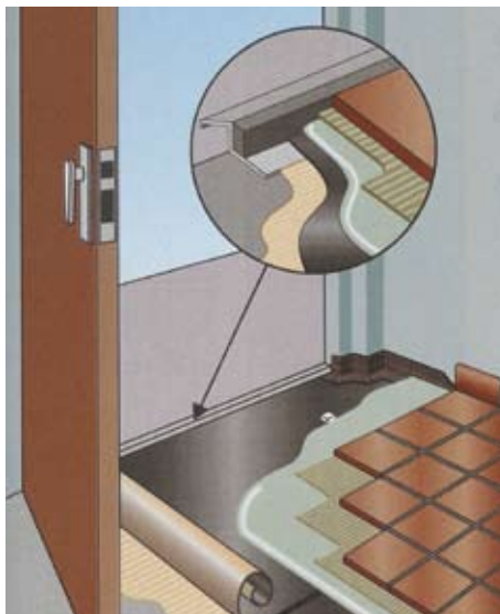
Řez aplikací systému „weber.sys acoustic“ s detailem řešení dveřní spáry. Sada na 15 m 2 stojí 12 600 Kč bez DPH, sada na 60 m 2 jen 48 000 Kč bez DPH (SAINT-GOBAIN WEBER TERRANOVA)
