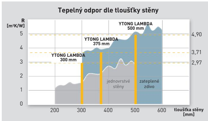
Stěna YTONG tloušťky 375 mm má stejnou tepelnou izolaci jako běžné tvárnice s 10 cm zateplením. Vysoká prodyšnost póróbetonu navíc stavbě umožňuje dýchat a zajišťuje také optimální vlhkostní klima v interiéru. Lepší pohoda tedy dosáhnete při nižší tloušťce a s nižšími investičními náklady než u jiných materiálů.
