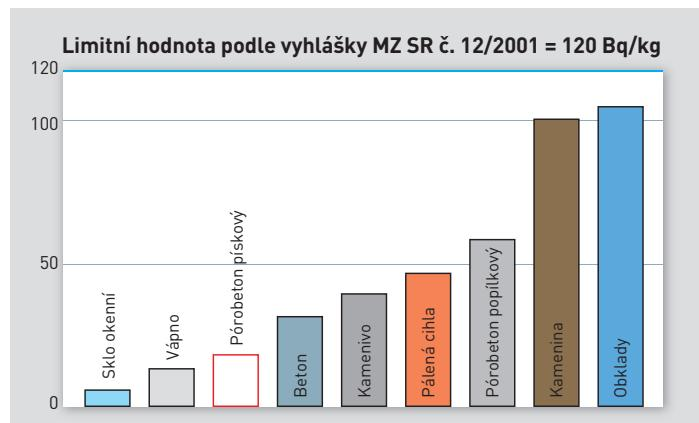
Bílý póróbeton má podstatně nižší obsah radioaktivních prvků než jiné zdící materiály.
