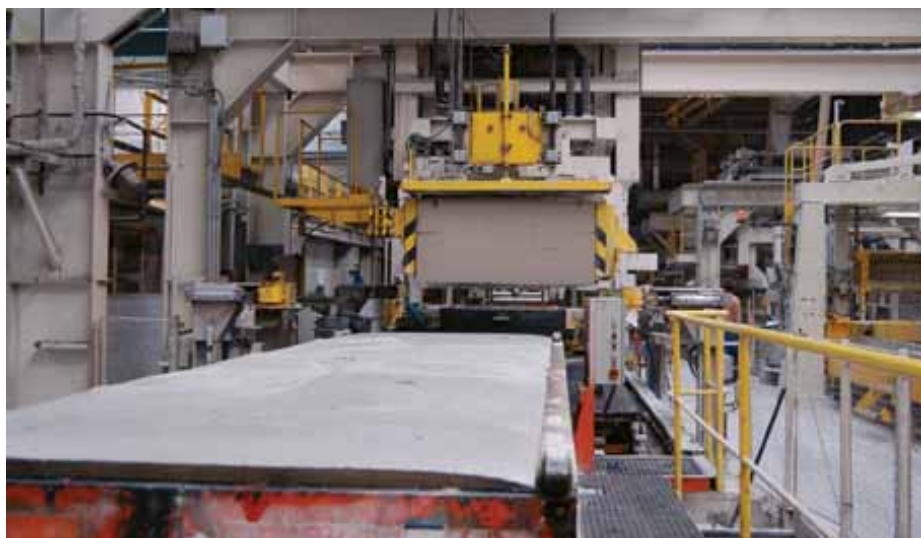
„Syrový“ pórobeton v líc formě již s potřebnými póry
