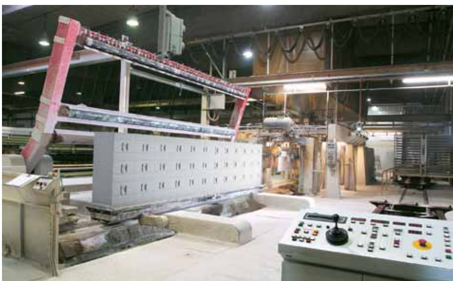
Řezací linka dokáže ze syrového pórobetonu vyrobit potřebné formáty s absolutní přesností
