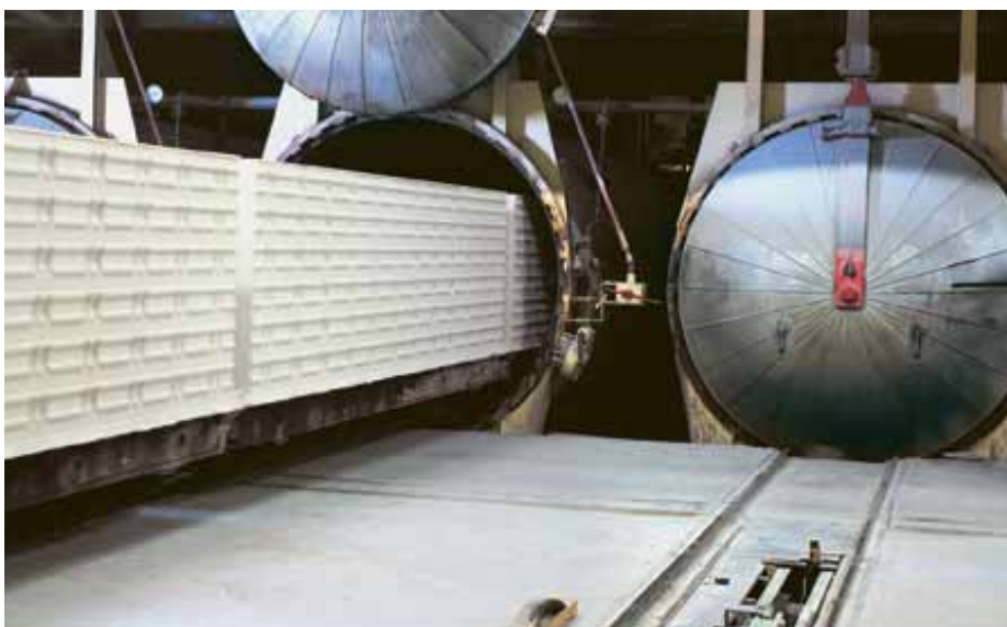
V autoklávech získává pórobeton díky krystalizaci potřebnou pevnost
