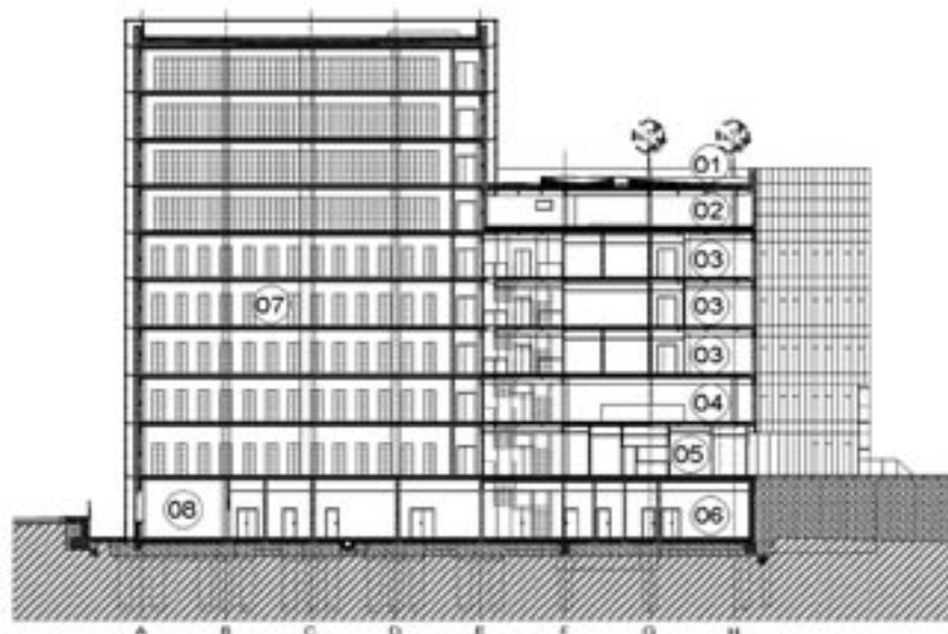
Příčný řez budovou: 01 – střešní zahrada, 02 – technické patro, 03 – administrativa, 04 – badatelna, 05 – foyer, 06 – prostor pro údržbu a skladování, 07 – depozitní sály, 08 – laboratoře a restaurátorské dílny
